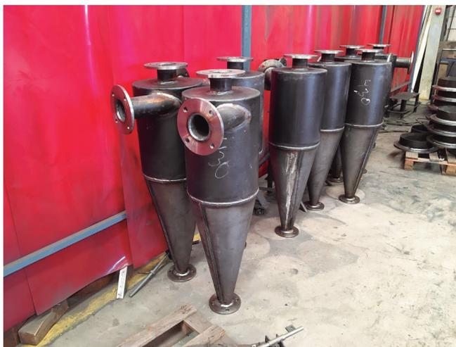
Figura 4. Fotografía de un conjunto de hidrociclones.
