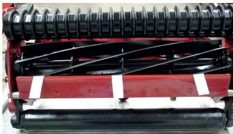
Otra forma de hacerlo es doblar el papel en dos, colocarlo perpendicular a la cuchilla base y la primera hoja debe ser cortada mientras la segunda es doblada y presenta marcas, si la segunda hoja no presenta marcas, la holgura será demasiado grande derivando en un corte defectuoso y un desgaste prematuro.
