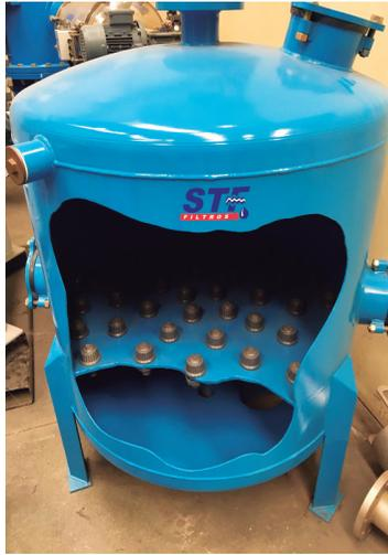
*Vista del interior de un filtro de arenas con detalle de las boquillas y del falso fondo.*
