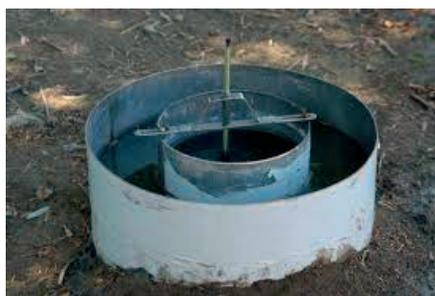
Se rellenan de agua ambos anillos y se toman mediciones de cuánto baja el nivel de agua del anillo interior y en cuánto tiempo, creando una tabla de resultados. El anillo externo sirve para saturar el terreno adyacente de manera que el movimiento del agua del anillo interior sea vertical y afecte en menor medida la diferencia de contenido en agua de toda la zona.
