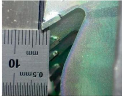
Detalle de ajuste de verticut John Deere a profundidad -3 mm preestablecido en el manual del operador.
