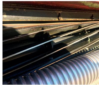
*Falta de ajuste. Exceso de apertura. Falta de venturi*
