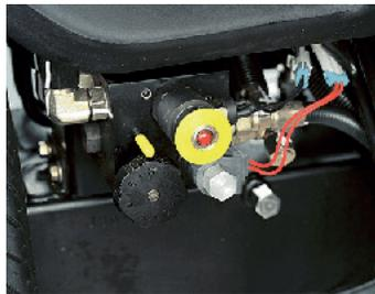
*Sistema de autoafilado incorporado en máquina John Deere.*
