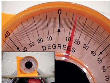
3. Sin modificar la posición de la unidad de corte apoyaremos el transportador de ángulos sobre la superficie de la cuchilla base.
