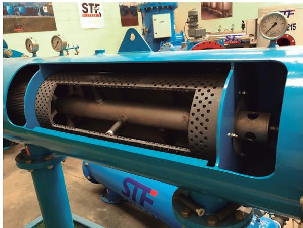
*Esquema de funcionamiento de un filtro de malla de limpieza automática.*
