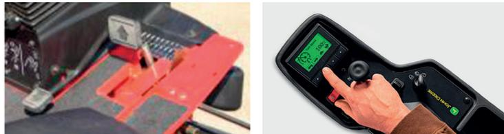
*Ajuste de velocidad de traslación Toro mediante uso de arandelas. Centralita de control John Deere (TechControl)*
