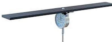
1. Colocamos la regla calibrada o regla de altura sobre el rodillo delantero y el rodillo trasero.
